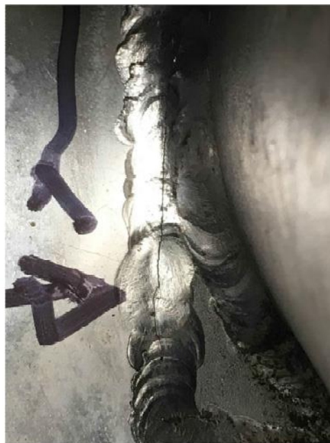
后支架与主轴/龙骨管之间的裂纹位置（可能在主轴任意一侧）
