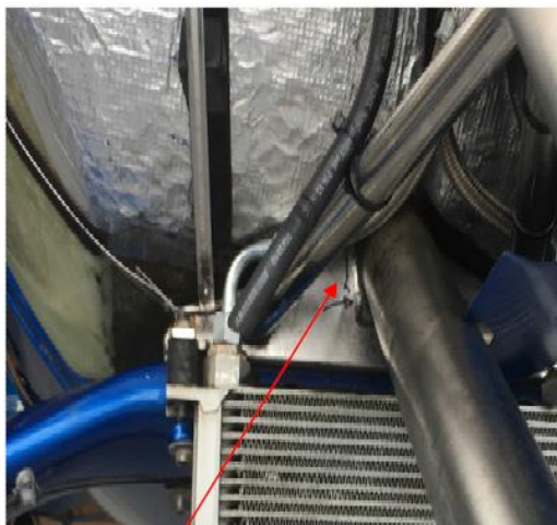
后支架与主轴/龙骨管之间的裂纹位置（可能在主轴任意一侧）
