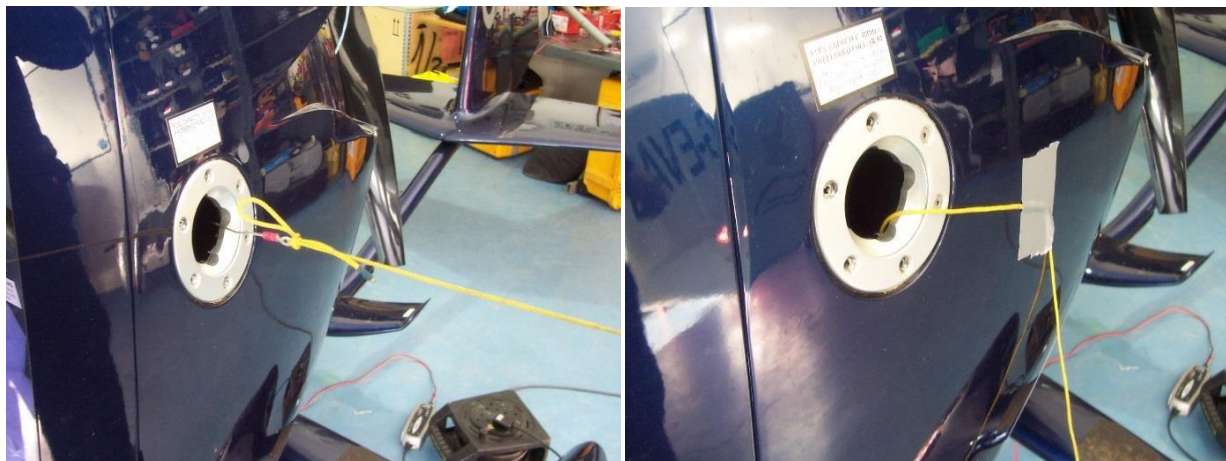
图 4+5:燃油加油口和接地编带安全绳
