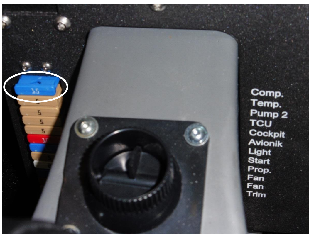
图 2:15A熔断器的压缩机
