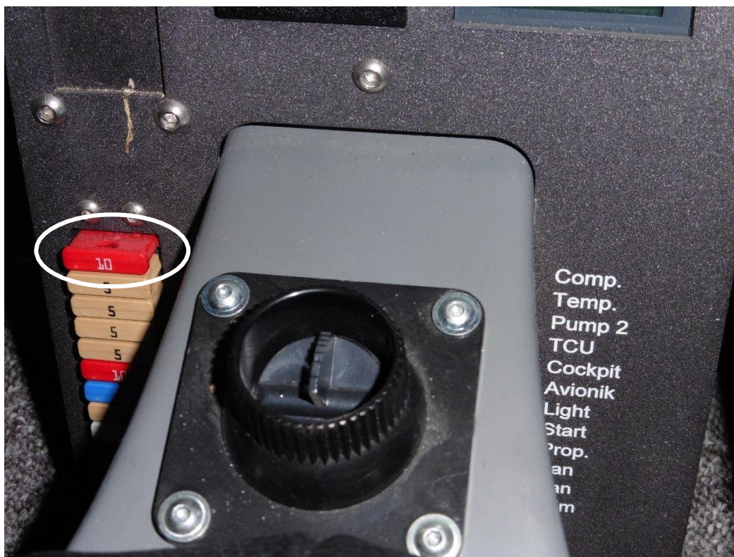
图 1:10A熔断器的压缩机
