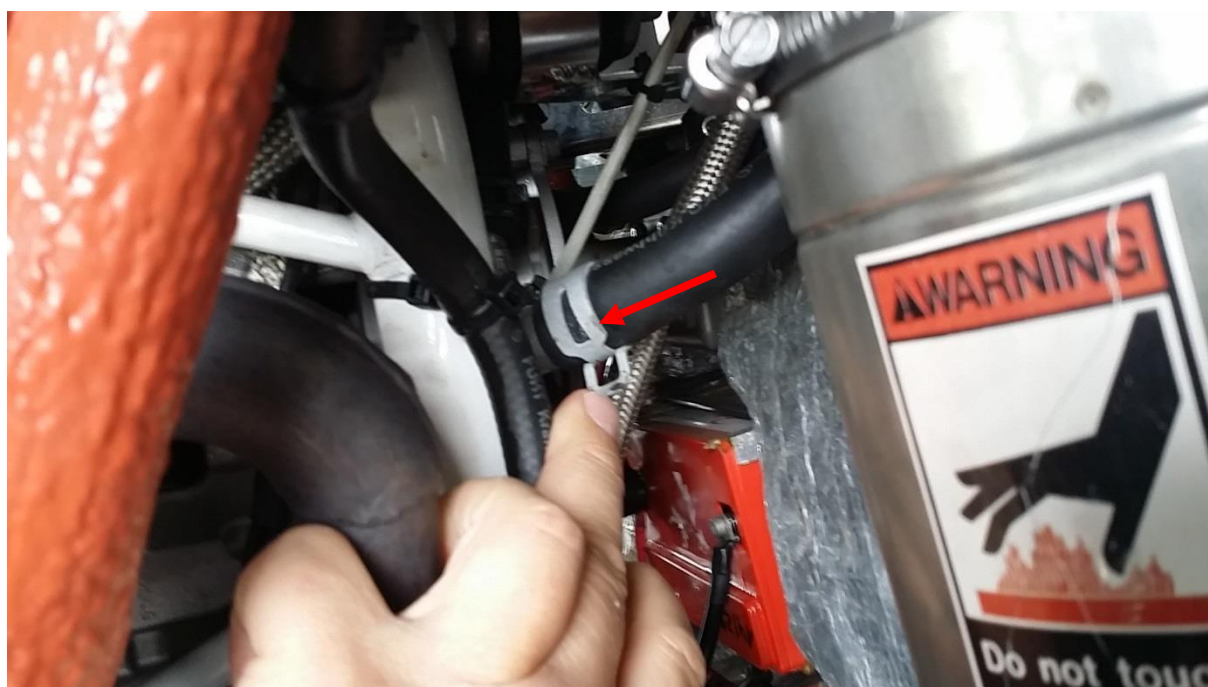
图 1 水管末端的管夹
