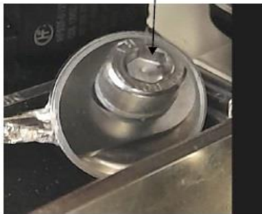
装上 Nord-Lock 垫圈的螺栓
