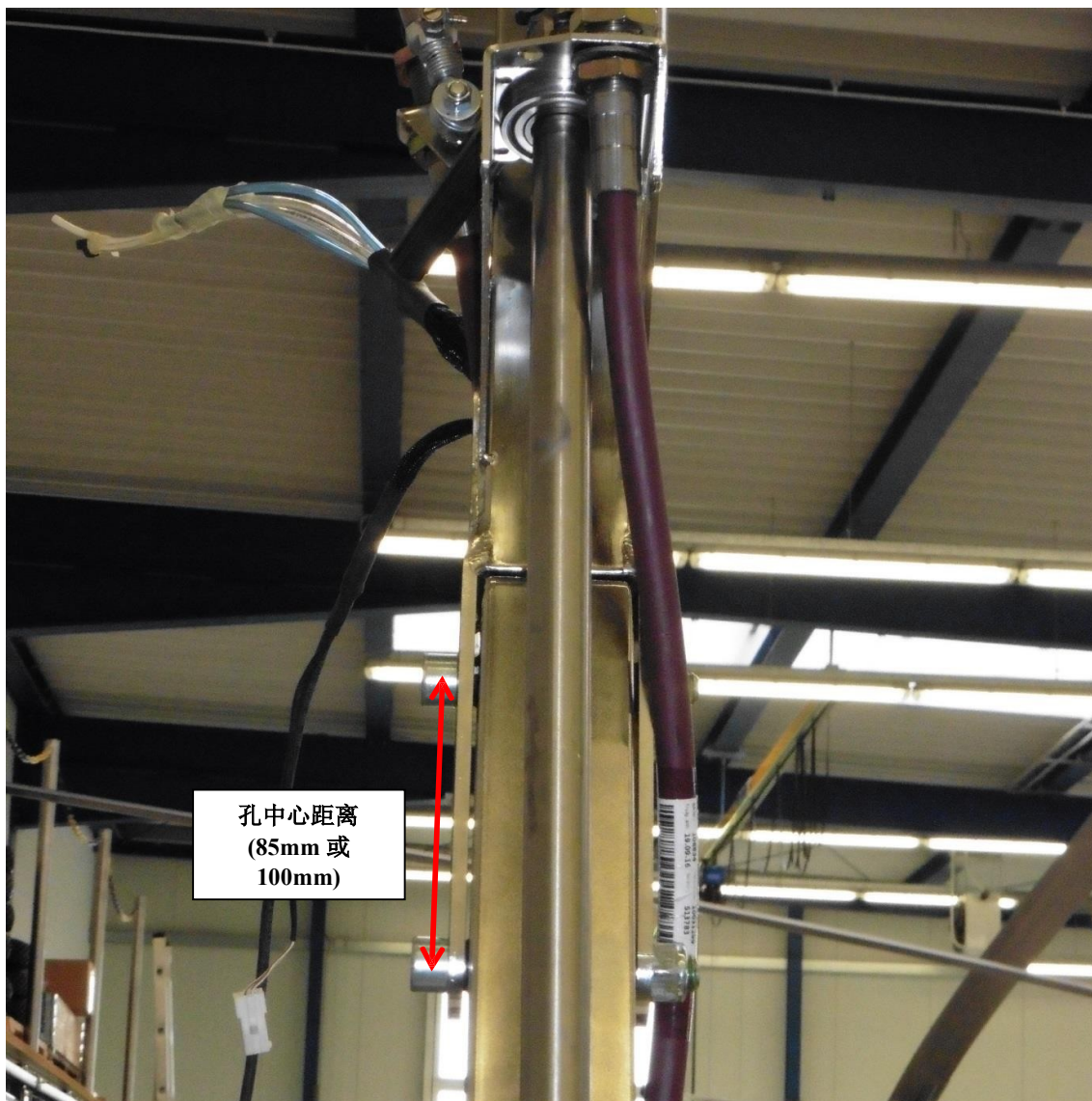
图 3:Calidus 上下主梁连接孔距
