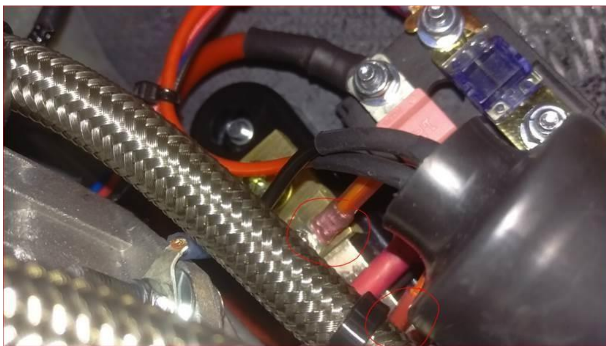
图4:新式安装的分流器
