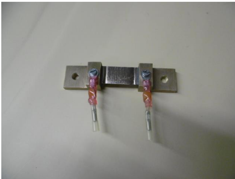
图3:新式安装的分流器
