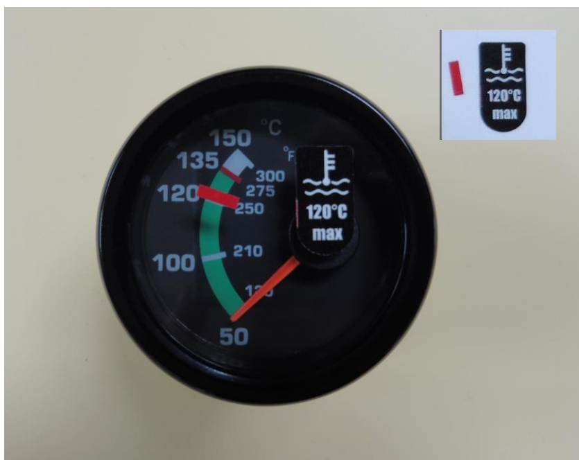
图3 - 汽缸头温度表改成冷却液温度表
