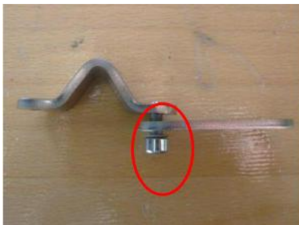
图 1: 连接的 PPC 夹具和 PPC V 型夹具
